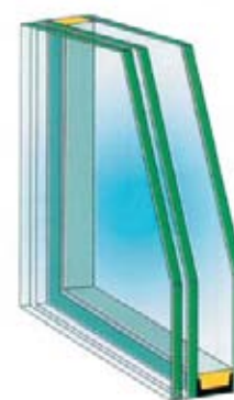
Vetro isolante e di sicurezza da mm. 25 (6/7 + 15 + 4) per pannello mm. 27-30
