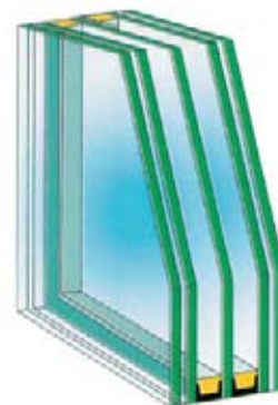
Vetro isolante e di sicurezza da mm. 34 (6/7 + 9 + 4 + 9 + 6/7) per pannello mm. 38-39
