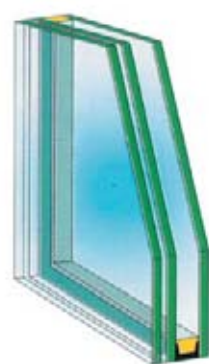
Vetro isolante e di sicurezza da mm. 16 (6/7 + 6 + 4) per pannello mm. 18-19
